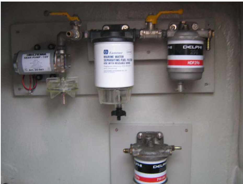
Monteret i kistebænken – det nederste filter er motorens forbrugsfilter
